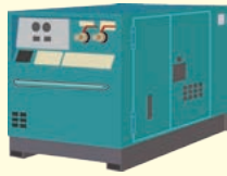
エアコンプレッサー
